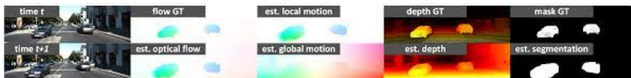
Résultats d'estimation de flot optique, profondeur et segmentation à partir de deux images avec la méthode EffiScene [3]
